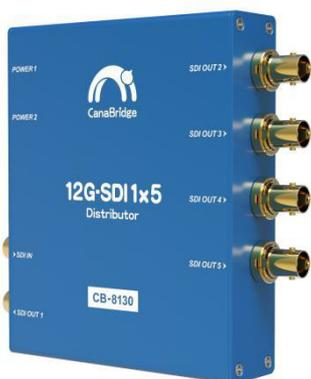
CB-8130为一个小型化的12G-SDI分配放大器。1×5分配，带时钟恢复。输入端 SD/HD/3G/6G/12G-SDI信号自适应。具备线缆均衡和时钟恢复。输出端口1、4、5支持ASI信号输出。
