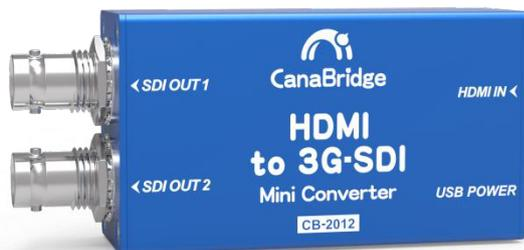
CB-2012 为精致的便携式HDMI到SDI转换器。微型USB电源接口，方便、可拆装的安装支架，CB-2011为室内与室外应用的最佳选择。HDMI A类输入接口和双3G-SDI输出，支持全高清(1080p60)到专业SDI信号的转换。SDI输出视频速率可以选择SD/HD/3G-SDI。
